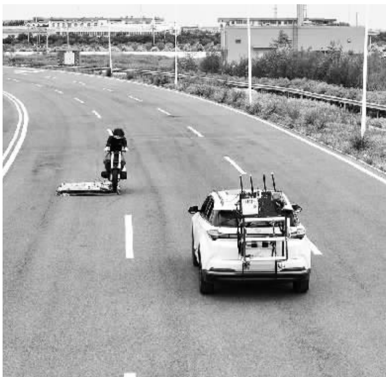
■封闭测试场内,一辆汽车正在进行自动驾驶主动安全功能测试。
