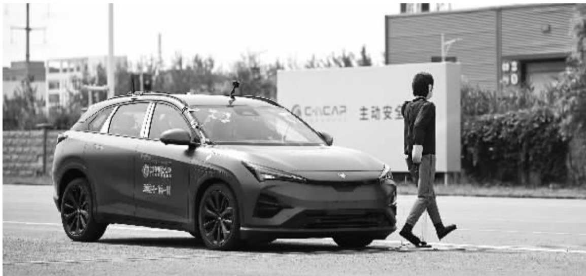
■一辆智能网联汽车在测试场内进行主动安全自动紧急制动测试。新华社记者 孙凡越 摄
