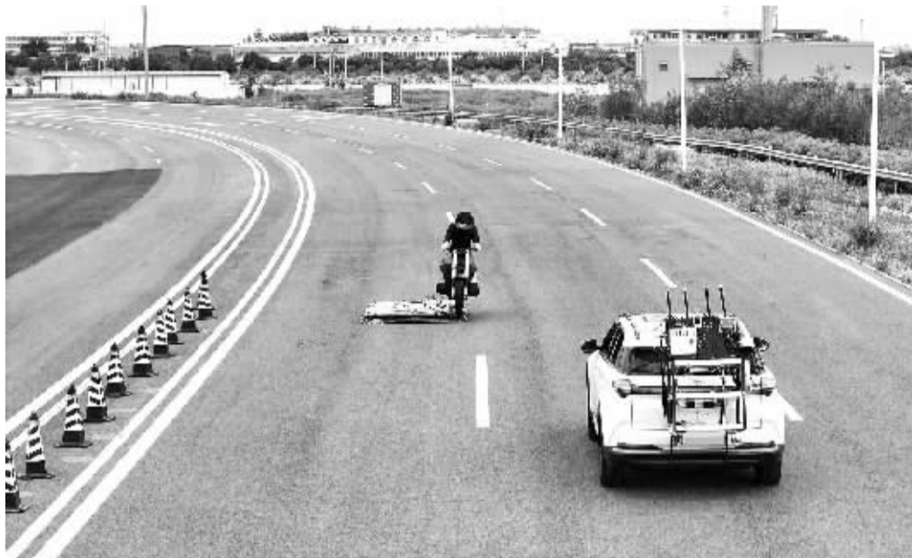
■封闭测试场内进行辅助驾驶主动安全功能测试。新华社记者 孙凡越 摄
