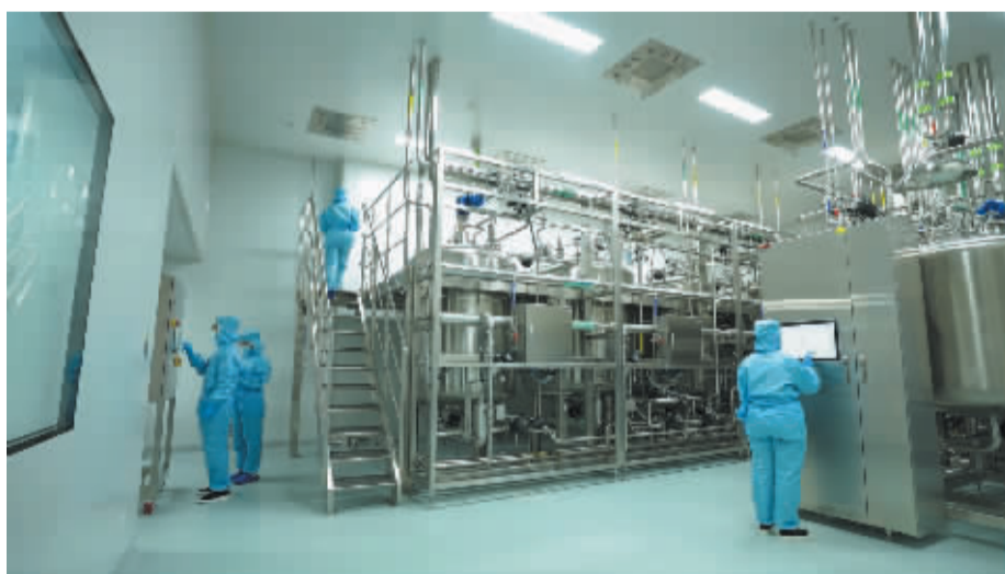
■技术人员在纯化商业化生产车间里进行超滤操作。(被采访单位供图)
