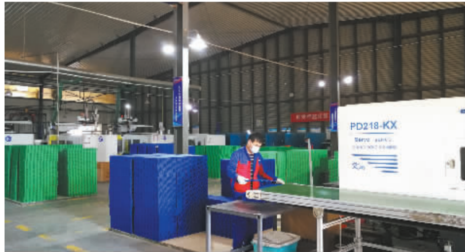
■拼装地板注塑生产线。(被采访单位供图)
