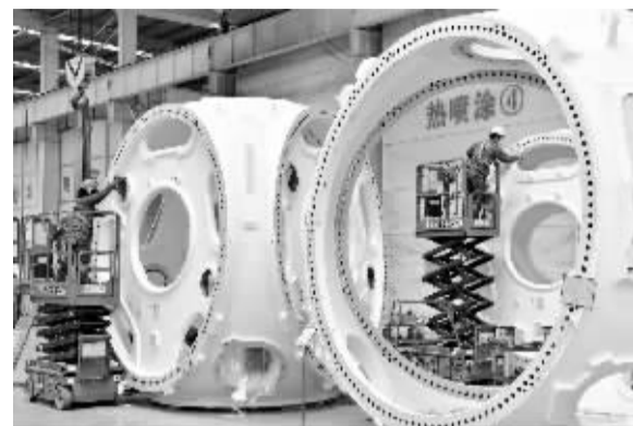
■1月25日,在位于山东省滨州市惠民县的山东国创精密机械有限公司,工作人员对风电轮毂进行喷涂作业。 新华社记者 郭绪雷 摄
