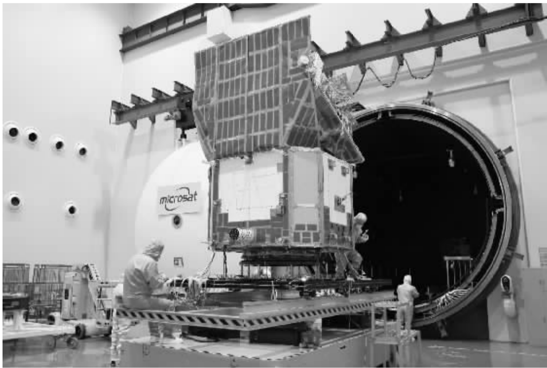
■2023年7月20日,在中国科学院微小卫星创新研究院,科研人员在做爱因斯坦探针卫星的热试验。 新华社发
