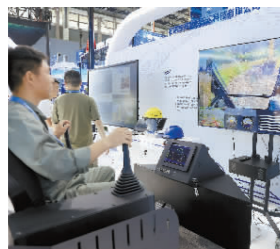
■石家庄开发区天远科技有限公司的工作人员正在远程操控一台挖掘机。
