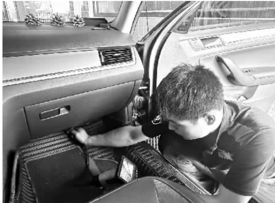
■维修师傅在对汽车空调的蒸发箱进行清洗。
