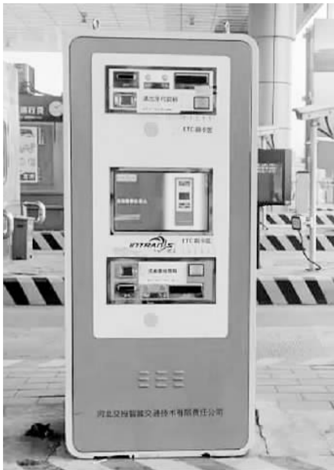
■收费岛亭处的收费机器人。(省交通运输厅供图)
