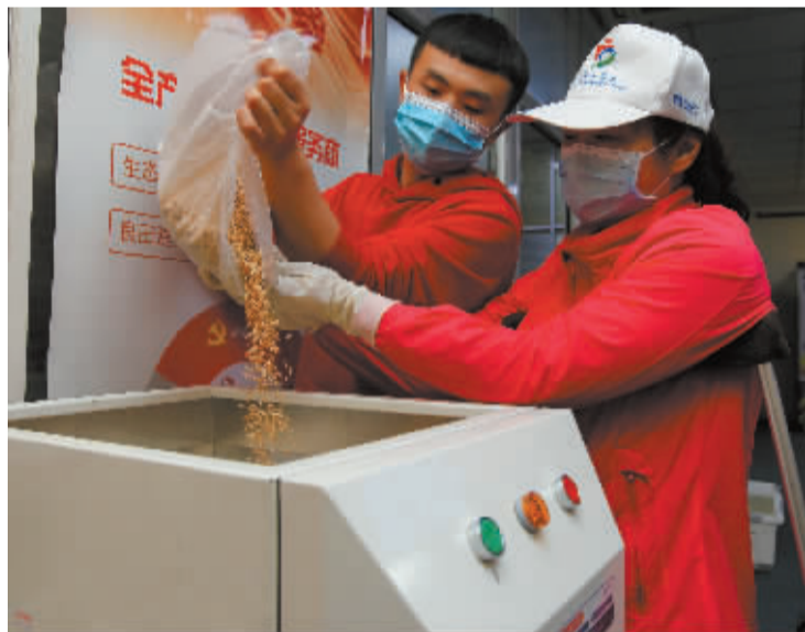
将稻谷倒进脱米机里。
