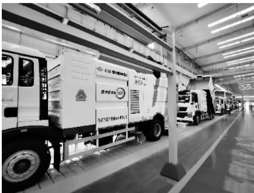
■ 环卫车自动化组装线上的纯电动四季多功能洗扫车。
