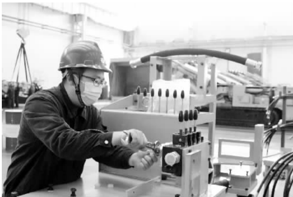
■ 装配车间工人正在组装煤矿智能掘进机的操作台。
