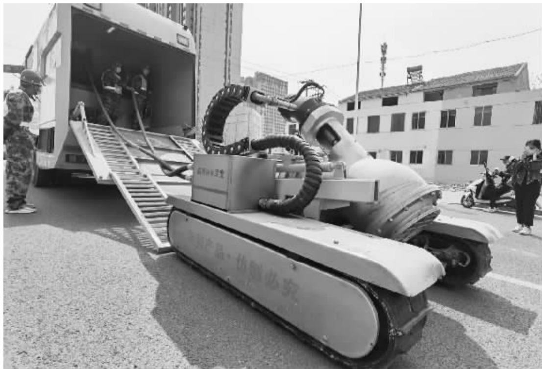
■履带式龙吸水排水抢险车可涉水作业。本报记者 李青 摄
